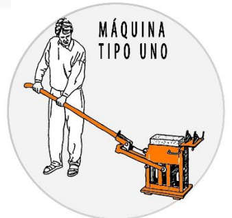
Fabrica entre 400 y 500 bloques de 9x14x29cm manualmente.
