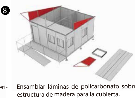
9 Ensamblar las láminas de policarbonato sobre estructura de madera para la cubierta.
